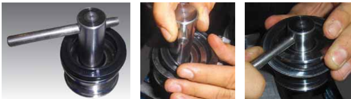
Figura 15 Instalación de juntas compactas
